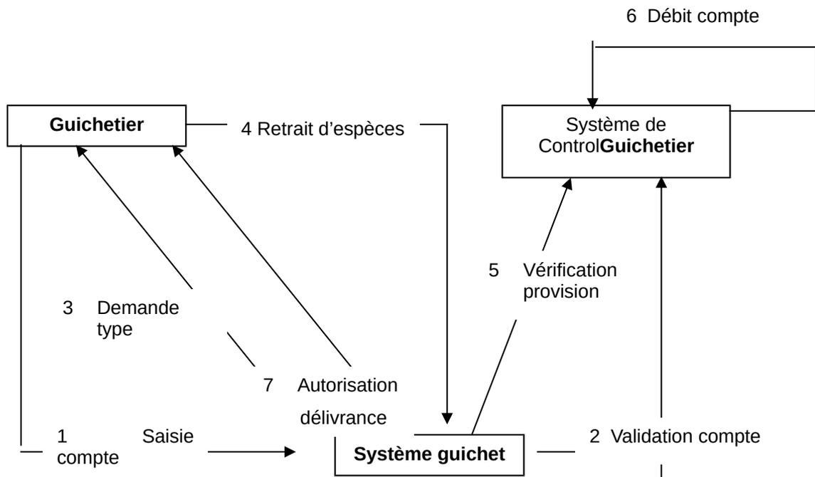
Dans ce diagramme, les **interactions** sont représentées par des flèches et la **chronologie par des numéros**. Cette notation devient vite difficile à lire pour les cas d'utilisation qui nécessitent beaucoup d'interactions. Par contre, **elle met en évidence les acteurs dont le rôle est important**. Les acteurs sont représentés par des rectangles placés n'importe où dans le diagramme. **Chaque acteur émet et reçoit des messages comme dans le diagramme de Séquence vu précédemment.**
